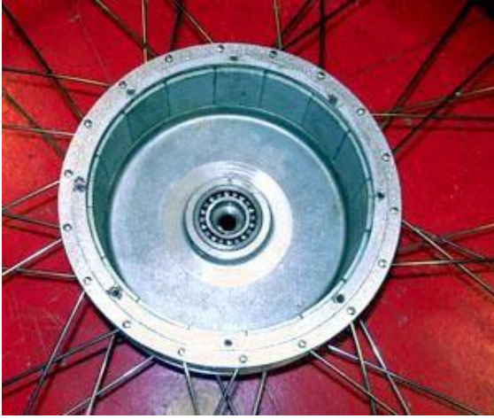
Şekil 2. Hub Motor Statoru
