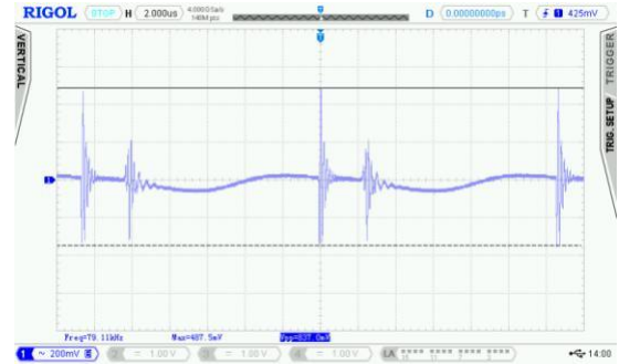
Şekil 8: X1Y2 Kapasitesi Yokken Çıkıştaki Parazit
