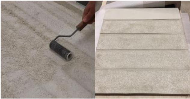
Şekil 1. Cam Elyaf Takviyeli Betonun içinde Elyafların dağılımı
