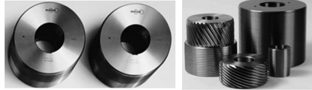
Şekil 1. Yuvarlak makaralar ve profillerinin fotoğrafları [9].
