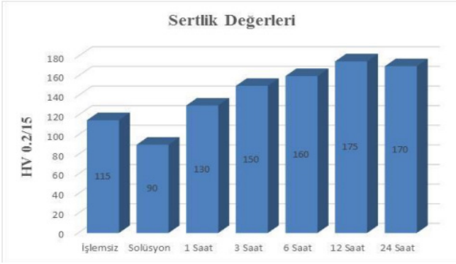
Şekil 19. Numunelerin sertlik değerleri
