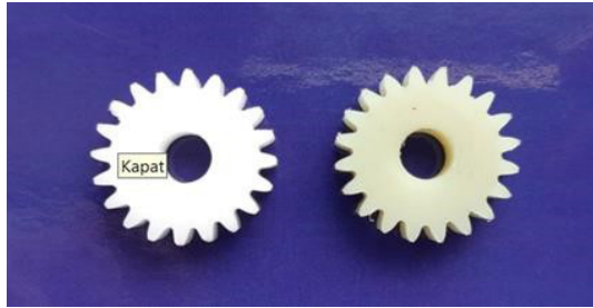
Şekil 2. Pom ve PA66 malzemelerinden üretilen dişli çarklar
