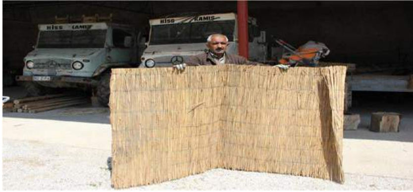
Şekil 10. Su kamıřının Isı yalıtımında kullanıma hazır materyal haline getirilmesi
