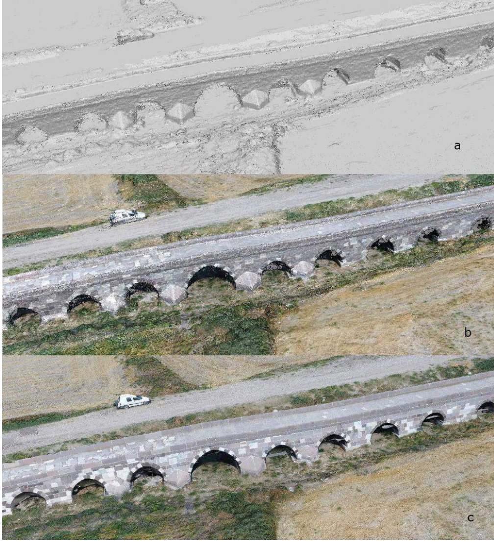
Şekil 5. a-) 3B nokta bulutu, b-) Renklendirilmiş 3B nokta bulutu, c-) Doku ile kaplanmış 3B model
