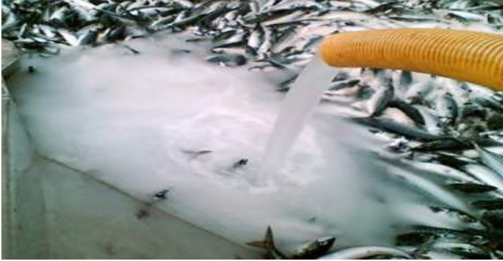
Şekil 2: Bulamaç buz ile soğutma
