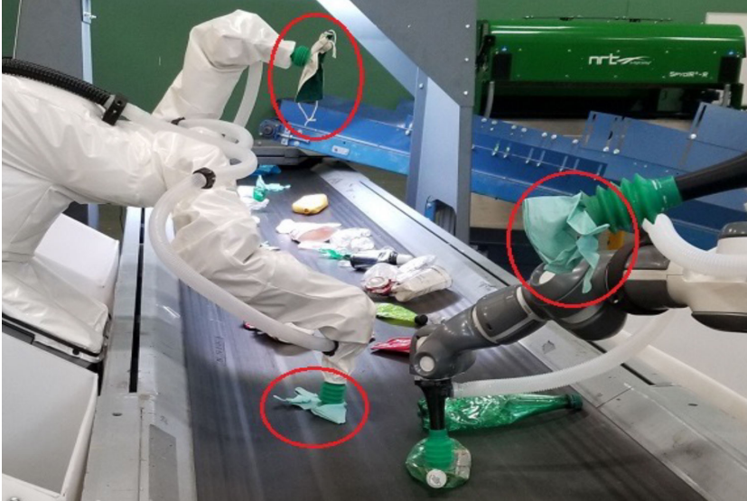
Şekil 2. Yapay Zeka Destekli Ayıklama Makineleri (MAX-AI AQC Yapay Zeka Destekli Ayıklama Makineleri)
