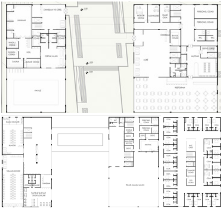
Şekil 16. Otel ve wellness centre binalarının kat planları
