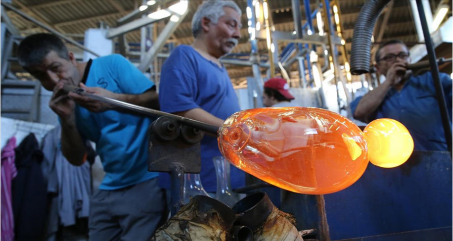
Şekil 16. Üfleme tekniği ile cam şekillendiren bir cam işçisi. (Anadolu Ajansı, 2021)
