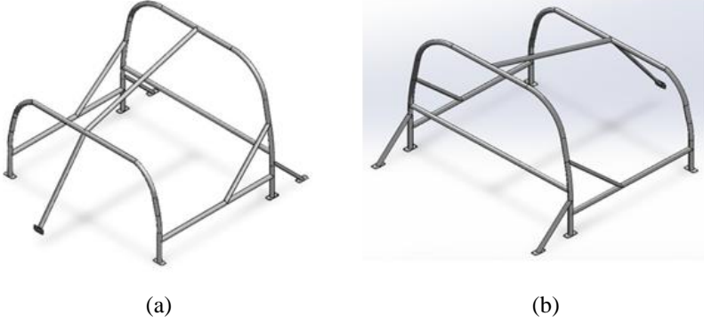
Şekil 1.a.b. Tasarımı gerçekleştirilen rollbar-rolcage'in ön ve arka açılardan katı model görünümü
