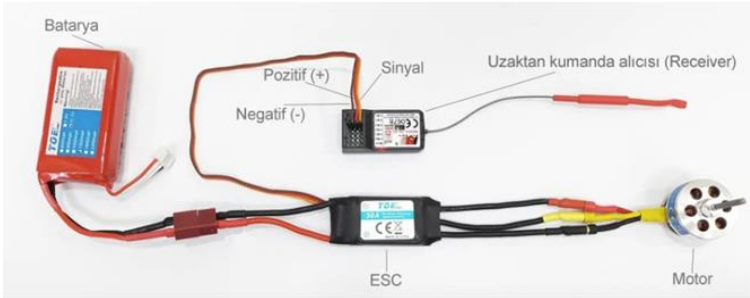
Şekil 3. ESC'nin motor ve çevre birimleriyle olan bağlantısı [27]
