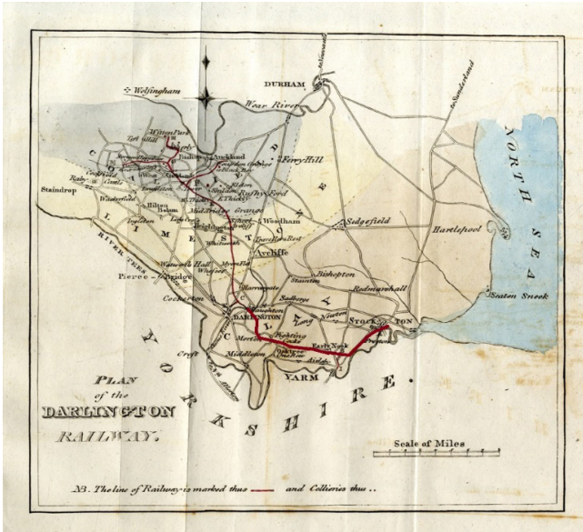
Şekil 3. Stockton-Darlington arasında inşa edilen dünyanın ilk halka açık demiryolu hattı (URL 3)
